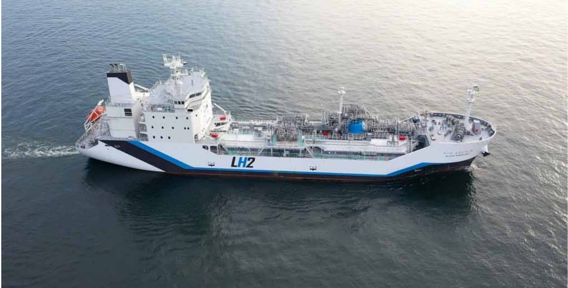
Imagen: MV: Frontier Suizo. Primer buque del mundo para el transporte comercial de hidrógeno líquido. Tomado de: https://webpicking.com/logistica-portuaria-del-hidrogeno-verde/
