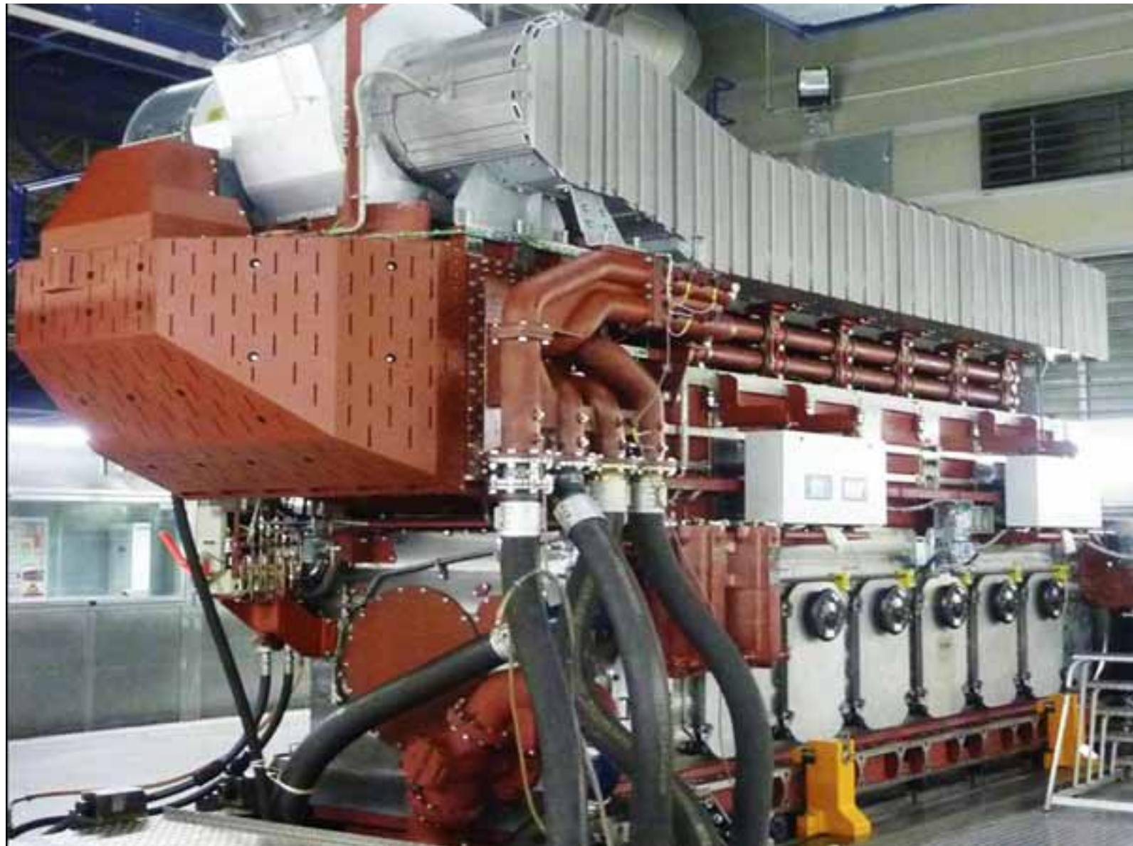
Imagen: Navegación limpia y eficiente con CAT: El nuevo motor marino quema tanto diesel como Gas Natural Licuado. Tomado de: https://gcaptain.com/efficient-clean-shipping-cat/
